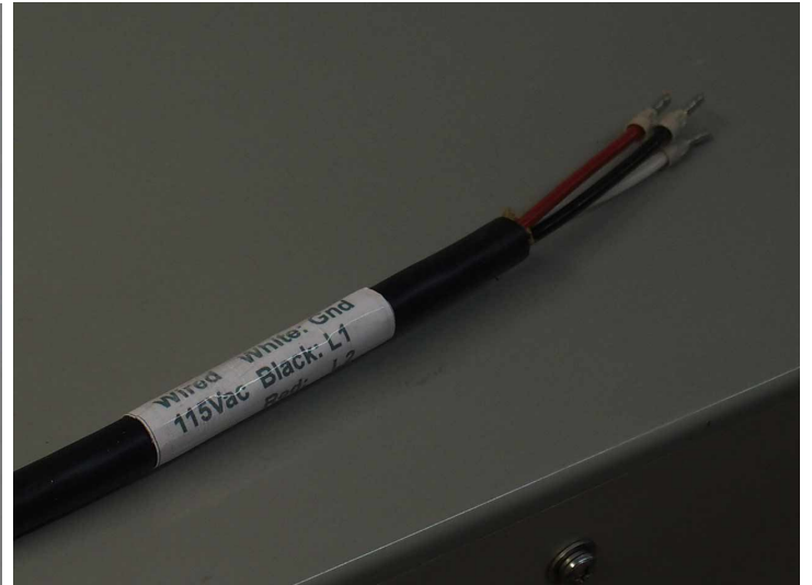
Reprise de l'extrémité, embouts laiton et fiche de repérage.
