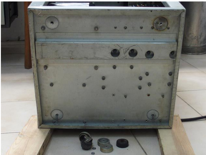
Partie inférieure, pieds incomplets ou manquants, roulette HS et inadaptée remplacés par 4 pieds PEHD confection maison.
