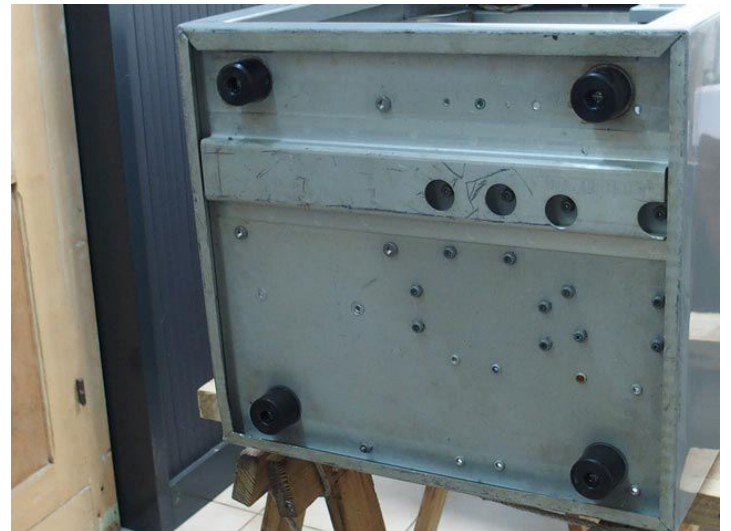
Partie inférieure, pieds incomplets ou manquants, roulette HS et inadaptée remplacés par 4 pieds PEHD confection maison.
