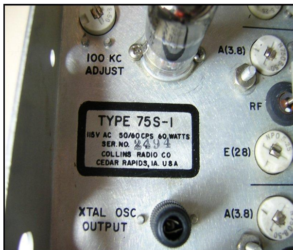
Fig.2 - La serie 2494 indica che il 75S-1 venne prodotto nel 1960
