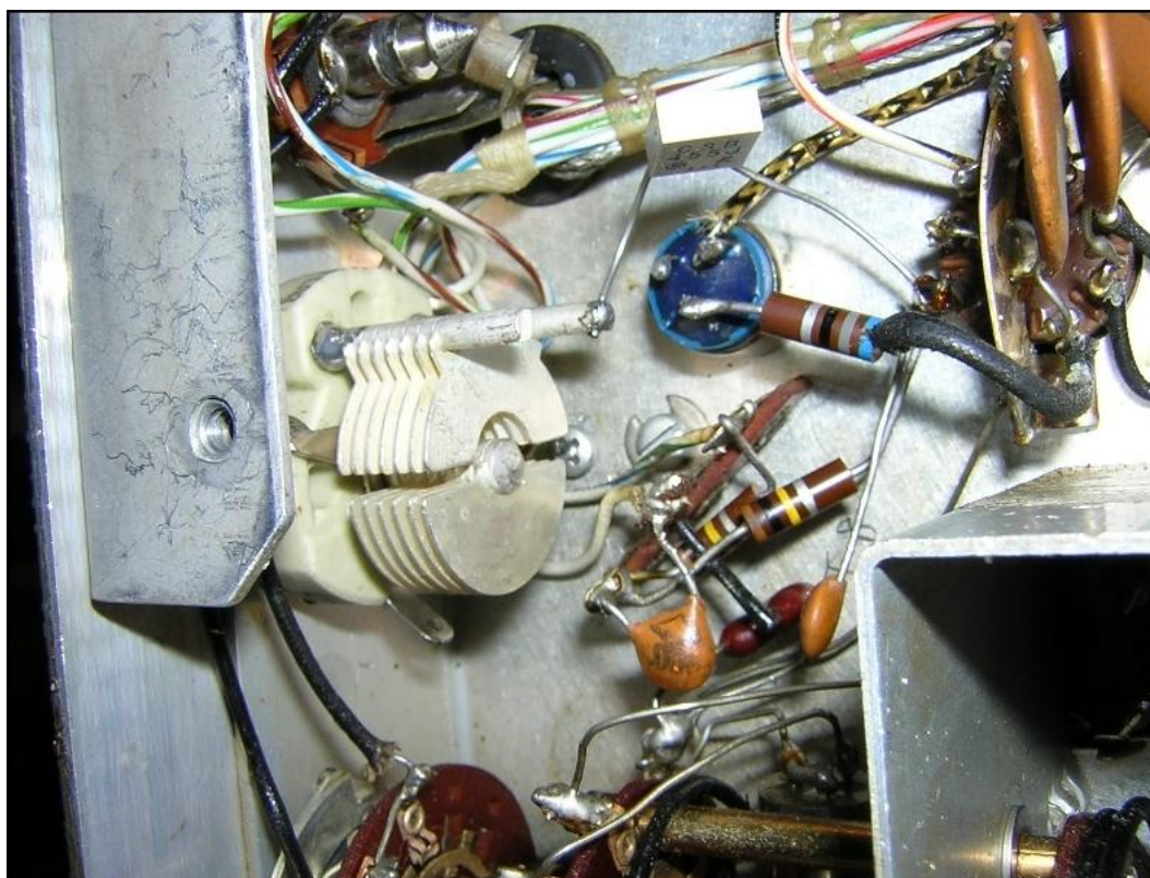
Fig.15 -Semplice circuito Notch con risonatore piezo-ceramico e condensatore variabile per la regolazione della frequenza di reiezione
